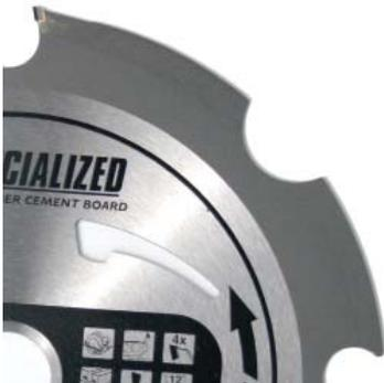
*Диск для резки цементоволокнистых плит. В состав напаяк данного диска включены искусственные алмазы для увеличения срока службы. Специальная форма зубов и режущей поверхности диска увеличивает его производительность и износостойкость.*
