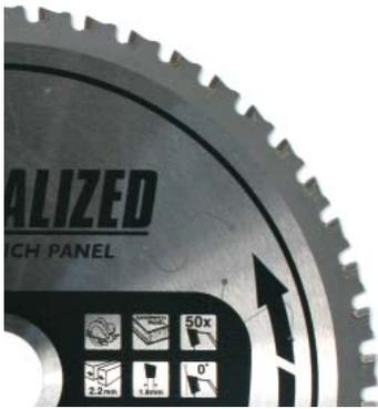
Линейка дисков специально разработана для резки металла или композитного материала, более известного как сэндвич-панель. Два листа металла, связанных изоляционным наполнителем. Предназначены для резки чистой резки без заусенцев и с низким теплообразованием, чтобы сохранить клеевую связь между двумя материалами.
