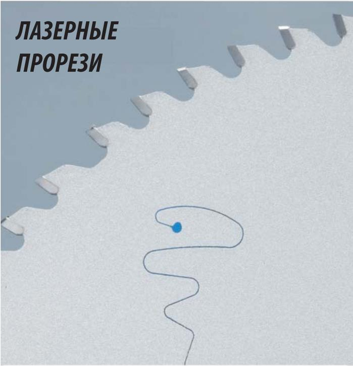
Новейшая система поглощения вибраций. Лазерные прорезы, заполненные резиновым компаундом, для гладких резов и снижения шума.
