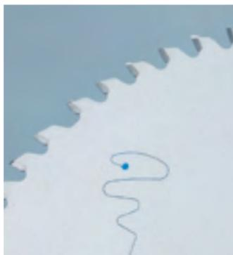
Специальные демпфирующие прорези, заполненные полиуретановым наполнителем. Это способствует уменьшению вибраций и снижению шума при резке.
