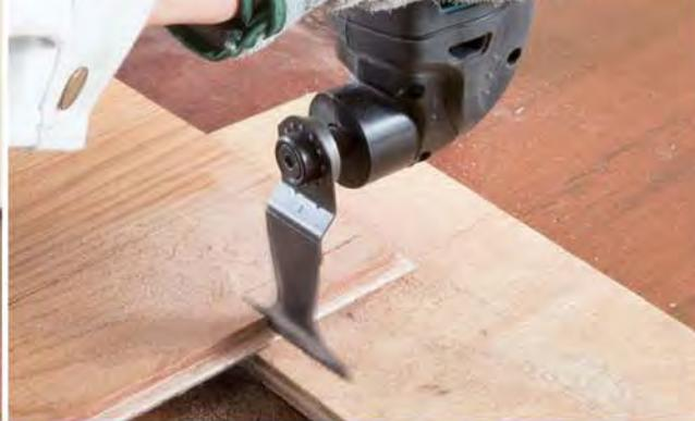
Резка дерева погружением
