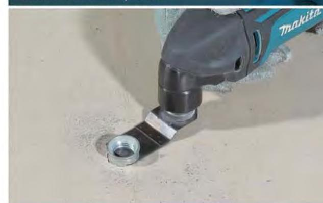
Резка металлических труб заподлицо
