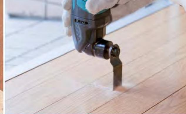
Глубокая резка дерева погружением
