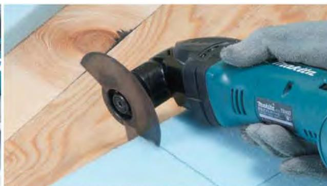
Резка пенопласта и резины
