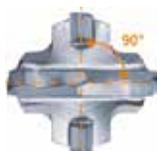
Симметричные, расположенные под углом 90°, 4 режущие кромки из высокопрочного твердого сплава гарантируют стабильное бурение даже в армированном бетоне.
