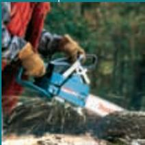
Компактная и прочная, универсальная пила для лесозаготовок, распиловки бревен, обрезки веток и расчистки кустарника. Инерционный тормоз цепи. Электронное зажигание. Автоматически регулируемая система смазки цепи. Конструкция инструмента обеспечивает защиту от вибраций. Быстрый запуск.
