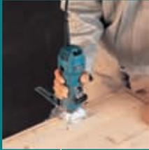
Эргономично удлиненный узкий корпус обеспечивает удобный захват и снижает утомляемость оператора. Резиновый ролик для легкой и точной настройки глубины фрезерования. 3707F: Встроенный светодиод для освещения рабочего места.
