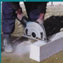
Алмазный диск (диаметр - 305 мм) обеспечивает максимальную глубину резки 100 мм. Функция плавного пуска. Мягкость и комфорт при резке. Эксклюзивная система привода с муфтой (Super Joint System™) от Makita предотвращает рывки инструмента при работе и пуске.
