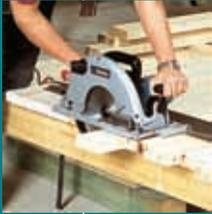
Функция мягкого пуска обеспечивает плавное включение пилы, без рывка. Упрощенная, более эффективная система удаления опилок. Расклинивающий нож для предотвращения заклинивания диска во время работы.
