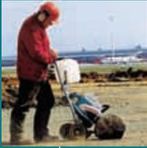
Направляющая тележка фирмы MAKITA PT-2000 WS с быстрым фиксатором Quick-lock. Благодаря патентованной зажимной системе Quick-Lock бензорезы с абразивными дисками фирмы MAKITA монтируются на направляющую тележку без помощи специальных инструментов.
