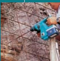
Три режима работы: долбление, сверление и сверление с ударом. D-образная рукоятка с резиновой накладкой для комфортной работы в самых тяжелых условиях. Патрон SDS plus. Бур просто вставляется в патрон одним движением руки.
