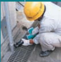
Невероятно низкая вибрация, благодаря системе балансиров в редукторе. -Смена ножовочного полотна и установка ограничительного упора без помощи инструмента. -Выключатель с блокировкой от случайного включения.
