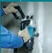
Чистота рабочей зоны, компактность и удобство использования. Штроборез от Makita предлагает наиболее эффективную вырезку пазов с чистой кромкой. Эргономичная конструкция рукоятки обеспечивает комфортные условия работы. Удобно расположенный передний кожух эффективно предотвращает разброс отходов резки при любой глубине реза.
