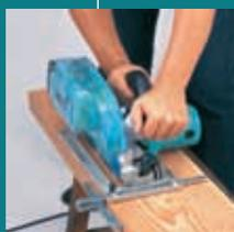
Контейнер для сбора опилок во время распиловки, обеспечивает чистое окружающее пространство на рабочем месте. Расклинивающий нож для предотвращения заклинивания диска во время работы.
