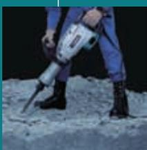
Чрезвычайно низкий уровень шума и уровень вибрации наряду с очень высокой мощностью. Фиксация выключателя для режима непрерывной работы. Эргономичная рукоятка с резиновой накладкой.
