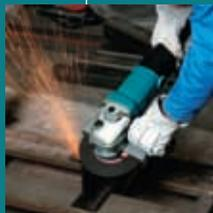
Компактная, легкая, эффективная угловая шлифовальная машина с высоким соотношением мощности и веса. Вес всего 3,5 кг снижает утомляемость оператора при непрерывной работе. Установка защитного кожуха, без специального инструмента. Пылезащитная конструкция для продления срока службы мотора. Электронный контроль скорости поддерживает скорость вращения диска под нагрузкой.
