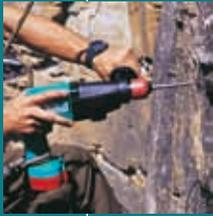
Три инструмента в одном: дрель, перфоратор и легкий отбойный молоток. Мощный мотор постоянного тока. Замена бура одним движением.
