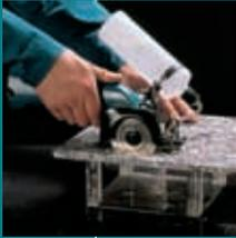
Для быстрой и легкой резки керамической плитки. Угол наклона при косой резке - до 45°. В комплект поставки входит емкость для охлаждающей жидкости.
