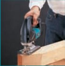
Быстрая, гладкая и аккуратная распиловка профессионального уровня. Чрезвычайно низкий уровень шума и вибрации. Электронный контроль скорости обеспечивает стабильную скорость для разных материалов. 3-х ступенчатый маятниковый ход. 4340FCT: встроенная светодиодная лампа для удобства контроля линии реза.
