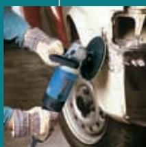
Электронный контроль скорости поддерживает постоянные обороты диска под нагрузкой. Плавный пуск. Фиксация выключателя для непрерывной работы на одной скорости.
