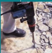
Превосходное соотношение мощности и веса (9,3 кг) и сниженный уровень вибраций. Сдвижной патрон для замены долота одним движением. Установка долота в 12 положениях. Электронная система контроля скорости повышает производительность. Световой индикатор напоминания о замене угольных щеток. Удобный ползунковый выключатель.
