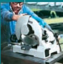
Для быстрой резки уголка, труб и швеллера. Настройка угла распила с помощью рычага, без вспомогательного инструмента. Прочный твердосплавный диск. Чистый рез без заусенцев, искр, прожига материала. Увеличенный срок службы по сравнению с абразивным диском.
