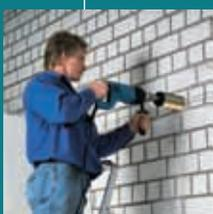
Дрель с мощным мотором (1400 Вт) для быстрого сверления железобетонных / кирпичных конструкций. Расцепляющая муфта разжимается по достижению предустановленного уровня. Электронный контроль скорости.
