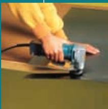
Конструкция лезвия обеспечивает работу без потерь материалов. Корпус-рукоятка с удобным выключателем обеспечивает легкость работы одной рукой. Особенности: нижнее ограждение для защиты руки оператора, блокирующий выключатель, встроенный измеритель толщины. Легкозаменяемые лезвия, с 8 режущими кромками. Чрезвычайно легкий вес (всего 1,7 кг).
