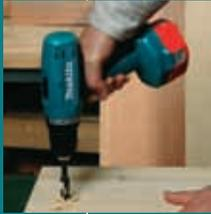
Компактный инструмент - длина всего 192 мм. Вес всего 1,6 кг для снижения утомляемости оператора. Полностью металлический редуктор обеспечивает исключительную надежность передачи. Увеличенная выходная мощность обеспечивает большую эффективность работы.
