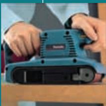
Компактные размеры и хорошая балансировка обеспечивают легкость работы. Уникальная конструкция позволяет шлифовать пол у края стены. Стационарное использование при установке струбицы (192694-6). Низкий уровень шума при работе (всего 85 дБ). Автоматическая система регулировки положения ленты. Регулировка скорости 9911K – в чемодане
