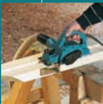
Мощный мотор 850 Вт, идеально подходит для фальцовки. Малый вес и прекрасная сбалансированность. Использование как односторонних твердосплавных ножей, так и двусторонних мини-лезвий. Простая система быстрой установки лезвия.
