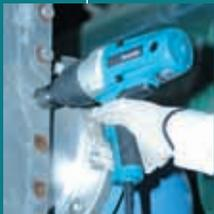
Алюминиевый корпус ударного механизма обеспечивает высокую надежность. Компактный размер корпуса: 251 мм. Эргономичная мягкая накладка на рукоятке. Доступ к угольным щеткам извне облегчает техническое обслуживание.
