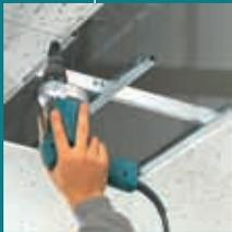
Идеальный шурупверт для древесины и металла. Ограничитель глубины завинчивания с точной регулировкой шага 0,18 мм. Стандартный патрон с внутренним шестигранником 6 мм. Практичная скоба крепящая инструмент к поясу. Реверс. Низкий уровень шума при работе.
