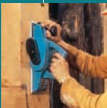
Обрабатывает поверхность шириной до 110 мм и глубиной до 2 мм за один проход. Мощный мотор (840 Вт) в легком и компактном корпусе (4,2 кг).
