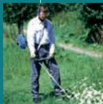
Легкая бензокоса с прямым валом. Применение различных косильных принадлежностей. 6-канальный цилиндр с тщательно рассчитанными фазами газораспределения.
