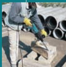
Мощный 2 кг перфоратор имеет D-образную ручку эргономичной линейной конструкции, для удобства использования. Три режима работы: сверление, сверление с ударом или долбление. Установка долота в 40 положениях без дополнительных принадлежностей. Регулируемая скорость вращения + реверс.
