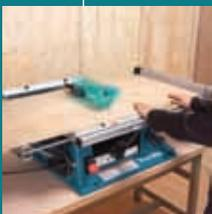
Настольная пила для очень точного реза. Мощный мотор позволяет выполнить распиловку бруса сечением до 100x200мм.
