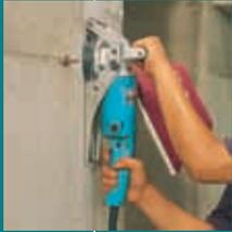
Для ровной окончательной отделки бетонных поверхностей или выравнивания бетонных швов. Алмазная чашка для сухой резки позволяет выравнивать поверхность без использования системы подачи воды. Пылесборник обеспечивает чистоту рабочей зоны. Фиксация кнопки для режима непрерывной работы.
