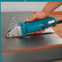
Новое боковое лезвие с узкой режущей кромкой для более чистой резки без деформации основного материала. Двойное лезвие, обеспечивающее меньшую деформацию материала, по сравнению с одинарным. Регулировка лезвия на различную толщину материала, сводит к минимуму образование заусенцев.
