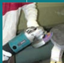
Предназначена для работ с бетоном и очень твердым камнем. Идеальна для шлифовальных работ. Специальная система привода с муфтой (Super Joint System™) от Makita предотвращает рывки инструмента при работе и пуске. Лабиринтное уплотнение защищает мотор и подшипники от загрязнения. Установка защитного кожуха, без специального инструмента. 9077SF: плавный пуск.
