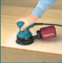
Гладкая и ровная шлифовка. Быстросменные абразивные листы (на липучке). Легкий корпус с эргономичной рукояткой, удобный для работы одной рукой, обеспечивает полный контроль над инструментом. Система контроля скорости поддерживает постоянное число оборотов под нагрузкой. Эффективная система пылеудаления через шлифовальную пластину.
