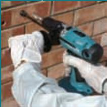
Мощная аккумуляторная ударная дрель-шурупверт с 3-мя скоростями. Высокая производительность благодаря мощному мотору. Полностью металлический редуктор для увеличения износостойкости. Отдельный переключатель режимов работы на корпусе.
