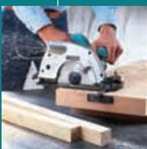
Облегченная конструкция с полностью на шариковых подшипниках редуктором, увеличивает срок службы инструмента. Расклинивающий нож для предотвращения заклинивания диска во время работы.
