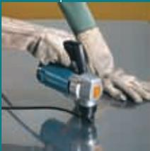
Для резки металлических, пластмассовых и прочих листовых изделий. Встроенный измеритель толщины. Легкая замена пуансона и матрицы. Удобная конструкция для работы одной рукой.
