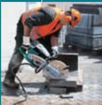
Система "двух масс" для снижения вибрации. 5-уровневая система фильтрации для работы в условиях сильной запыленности. Магниевый кожух, изготовленный методом литья под давлением. Карбюратор: с диафрагмой, стартер: механический.
