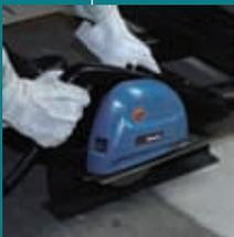
Дисковая пила по металлу (диаметр 185 мм) для резки стальных изделий с толщиной стенки до 6 мм. Чистая резка с высокой скоростью. Резка с минимальным количеством заусенцев, искр и прожига материала.
