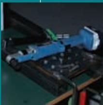
Специально разработан для выполнения крепежных операций на автосборочных производственных линиях. Курковый выключатель работает с задержкой в 1 сек. между циклами завинчивания, для недопущения перезатяжки. Невероятно точное завинчивание шурупов. Светодиодный индикатор и звуковой сигнал оповещают об условиях затяжки и рабочих режимах инструмента. Лампа точечной подсветки.
