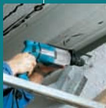
Металлический корпус редуктора, обеспечивает надежность и длительный срок службы инструмента. Быстрозажимной патрон.
