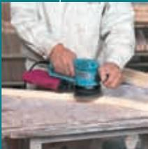
Превосходная отделка поверхности благодаря двойному (вибрационному и вращательному) движению шлифовального диска. Эффективная система пылеудаления через шлифовальную пластину. BO5021 – регулятор скорости.
