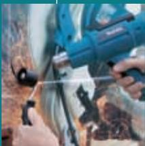
Многофункциональная термовоздуходувка с мощным нагревательным элементом. Электронный регулятор, поддерживающий постоянную температуру вне зависимости от скорости потока и потребляемой мощности. Программирование 7 различных функций выбором одной клавишей.
