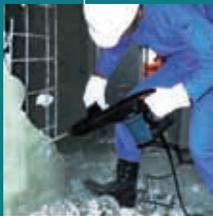
Мощность 1100 Вт в компактном и легком (4,7 кг) корпусе. Удобство работы благодаря прямолинейной конструкции корпуса инструмента. Электронная система контроля скорости повышает производительность. Световой индикатор напоминания о замене угольных щеток. Установка долота в 12 положениях. Удобный ползунковый выключатель.
