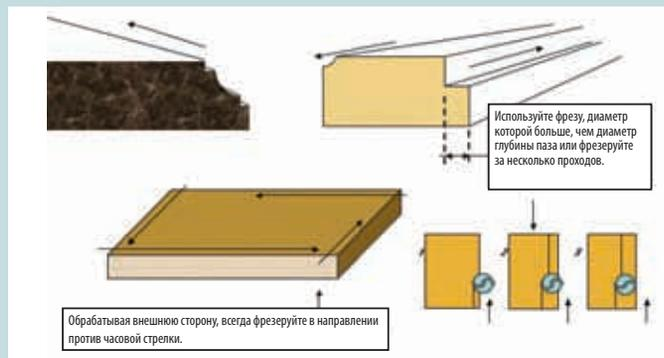
**Параллельный упор для прямолинейного фрезерования.** Параллельная направляющая необходима для фрезерования различных пазов параллельно с кромкой заготовки.
