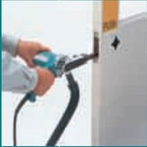
Длина опоры шлифовальной ленты 110 мм. Направляющая поворачивается на 100° для шлифования в труднодоступных местах. Электронная регулировка скорости. Простая настройка положения шиф. ленты с помощью поворотной ручки. Специальная система пылеудаления MAKITA. Дополнительные направляющие (6 мм и 13 мм) для широкого спектра работ по шлифовке и зачистке.
