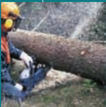
Профессиональная бензопила с эргономичным дизайном корпуса. Лучшее соотношение мощности и веса (1 л.с на каждый кг веса). Всего 6,3 л.с при 6,3 кг. Улучшенная фильтрация воздуха при помощи системы Airmaster. Упрощенный пуск благодаря полуавтоматическому арретуру полугаза. Жесткие стальные пружины для виброгашения. Декомпрессионный клапан.
