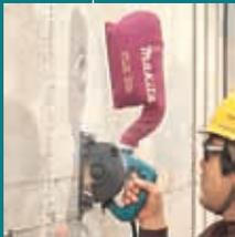
Популярный инструмент с эффективной системой пылеудаления для быстрой и чистой сухой резки керамической плитки. Мотор с защитой от перегрузки.
