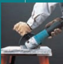
150 мм шлифовальная машина весом всего 2,4 кг, чрезвычайно удобна для работы одной рукой. Специальная система привода с муфтой (Super Joint System \*) от Makita предотвращает рывки инструмента при работе и пуске. Установка защитного кожуха без вспомогательного инструмента. Автоматическое отключение щеток. 9566CV: регулировка скорости вращения.
