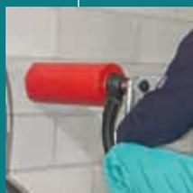
Дрель для сухого и мокрого сверления с алмазной коронкой и мощным (1700 Вт) мотором обеспечивает безударное и точное сверление поверхностей из бетона и натурального камня.
