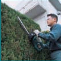
Три выключателя: на рукоятке, передней и нижней ручках. Лезвия начинают движение, только если одновременно нажаты любые два из трех выключателя. Двухстороннее лезвие обеспечивает точное подравнивание.
