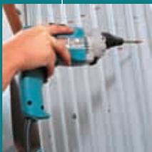
Мощный крутящий момент обеспечивается редуктором с двумя передачами в металлическом корпусе.
