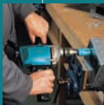
Мощный двигатель и понижающий число оборотов редуктор, увеличивают крутящий момент. D-образная рукоятка вращается на 360°, для работы в разных положениях. Кулисный переключатель для удобства управления дрелью. 6013BR: Промышленный патрон рассчитан на тяжелые условия работы. 6013BR: Реверс.
