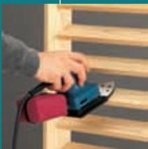
Оптимальна для обработки углов и труднодоступных участков, благодаря треугольной шлифовальной пластине. Использует быстросменные листы абразивной бумаги (на липучке).
