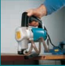
Мощный мотор для тяжелых условий резки мягких и нержавеющей сталей. Резка без потерь материала на задиры и заусенцы. Отличное поле зрения оператора обеспечивает точность резки. Большая верхняя рукоятка для полного контроля над инструментом во время работы. Лезвия с 4 режущими кромками. Встроенный измеритель толщины для удобства работы.
