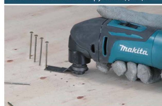
Резка гвоздей заподлицо
