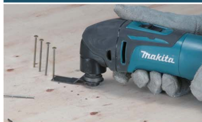
Резка гвоздей заподлицо
