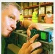
Небольшой, компактный и удобный лазерный дальномер для измерения расстояния, объёма и площади. Информативный большой трехстрочный дисплей с подсветкой. Разделённые функции: измерение длины по формуле Пифагора, таймер задержки времени, вычисление объёма и площади, функция разметки. Сложные измерения. Запоминание произведённых измерений и вычислений. Профессиональный расчёт.
