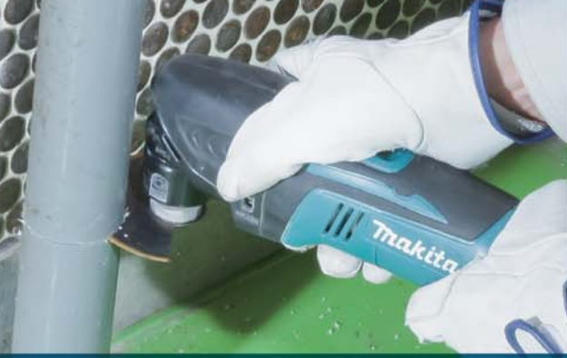
Резка труб из ПВХ и стеклопластика
