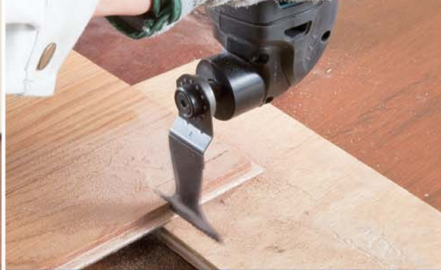
Резка дерева погружением
