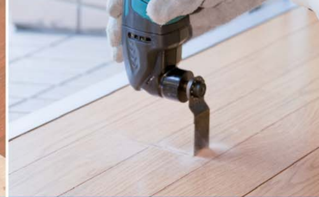
Глубокая резка дерева погружением
