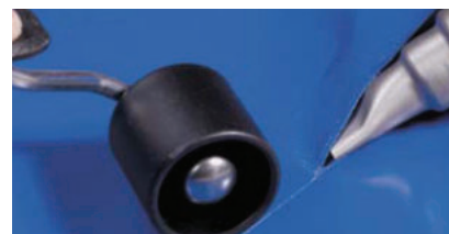
Спайка швов (только HG651C)
