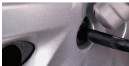
Ослабление затяжки винтов
